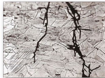
Högre förstoring: sprickvägarna delvis interkristallina och delvis transkristallina
