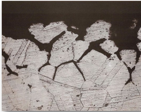
Interkristallin korrosion i ett tryckkärl efter felaktig värmebehandling som orsakat utskiljning av kromkarbider
