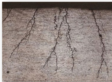
Sprickor, typiskt förgrenade har löpt 4 mm, plåttjocklek 5 mm
