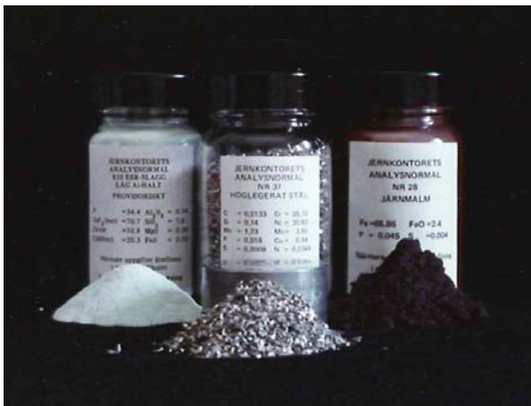
Jernkontorets certifierade referensmaterial, CRM, används för såväl kalibrering av instrument som kvalitetskontroll av slutprodukter.
