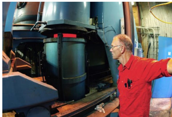
Het isostatisk pressning (HIP) av stålpulver i kapsel vid Erasteel Kloster. Foto: Stig-Göran Nilsson, Jernkontorets bildarkiv.
