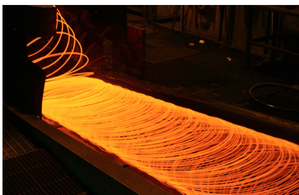
Tillverkning av valstråd vid Fagersta Stainless. Foto: Stig-Göran Nilsson.
