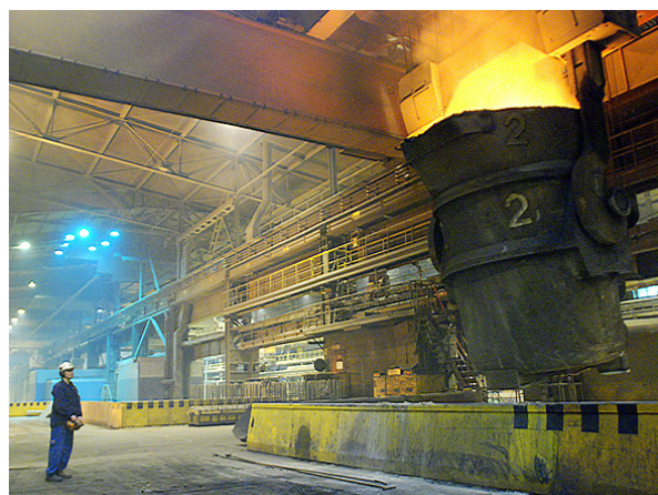
Förflyttning av en skänk med flytande stål. Foto: SSAB.
