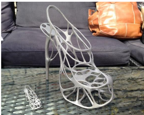
3D-printade skor i stål. Den stora skon (storlek 38) är tillverkad av Sandvik. Den något mindre skon till vänster (storlek okänd) är tillverkad av Höganäs.
