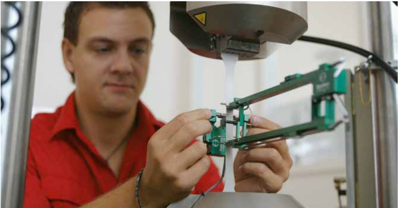
Mekanisk provning görs för att verifiera att ett material eller en produkt håller de utlovade egenskaperna. Två av de mest använda metoderna är dragprovning (bilden) och böjprovning. Foto: Stig-Göran Nilsson.
