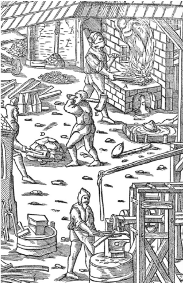
Direkt järnframställning i så kallat rännverkssmide, enligt Agricola 1555. Bilden illustrerar en artikel, om direkta järnframställningsmetoder, Malmsmide , på den nystartade historiska bloggen, jernbloggen.se
