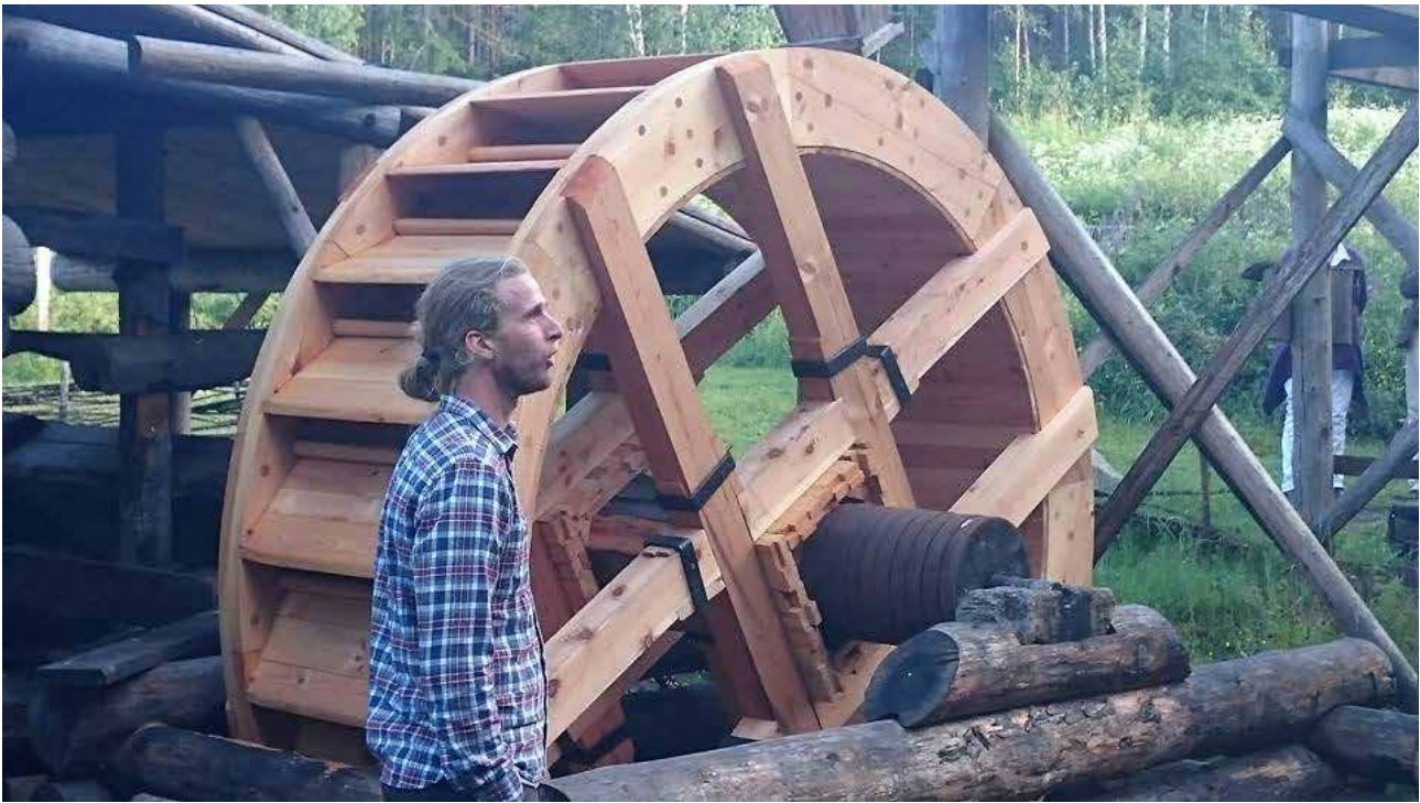
I juli fick Nya Lapphyttan ett nytt vattenhjul. Elias Berg (bilden) som konstruerat vattenhjulet berättade om tillverkningen i samband med invigningen. Foto: Föreningen Järnet på Lapphyttan.
