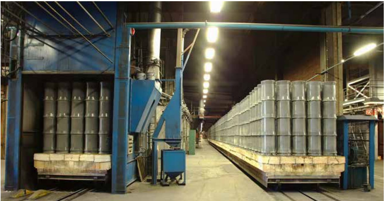
Ett av teknikområde 51:s projekt ska undersöka om impinging jet-tekniken kan användas för att öka kyleffekten i kylzonen på en tunnelugn (till vänster i bild) hos Höganäs. Foto: Stig-Göran Nilsson.
