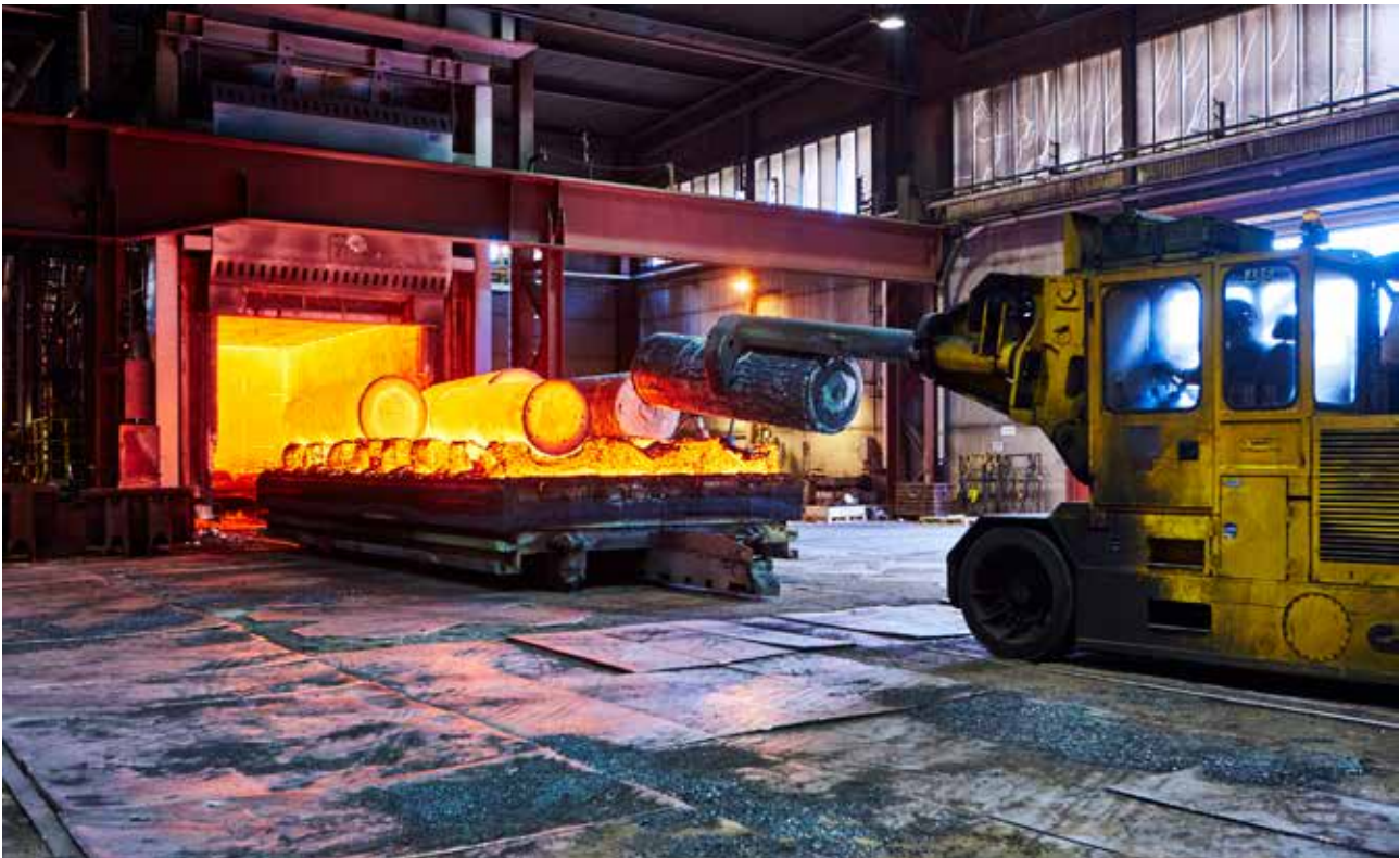
Värminingsugn för ESR-göt hos Uddeholms AB, ett av medlemsföretagen i teknikområde 51, Energi- och ugnsteknik. ESR (Electro Slag Refining) är en efterbehandlingsprocess där stålet genomgår en omsmältning, vilket ger stålet en struktur och en renhet som resulterar i ökad utmattningshållfasthet och andra goda egenskaper. Foto: Pia Nordlander, Bildn.
