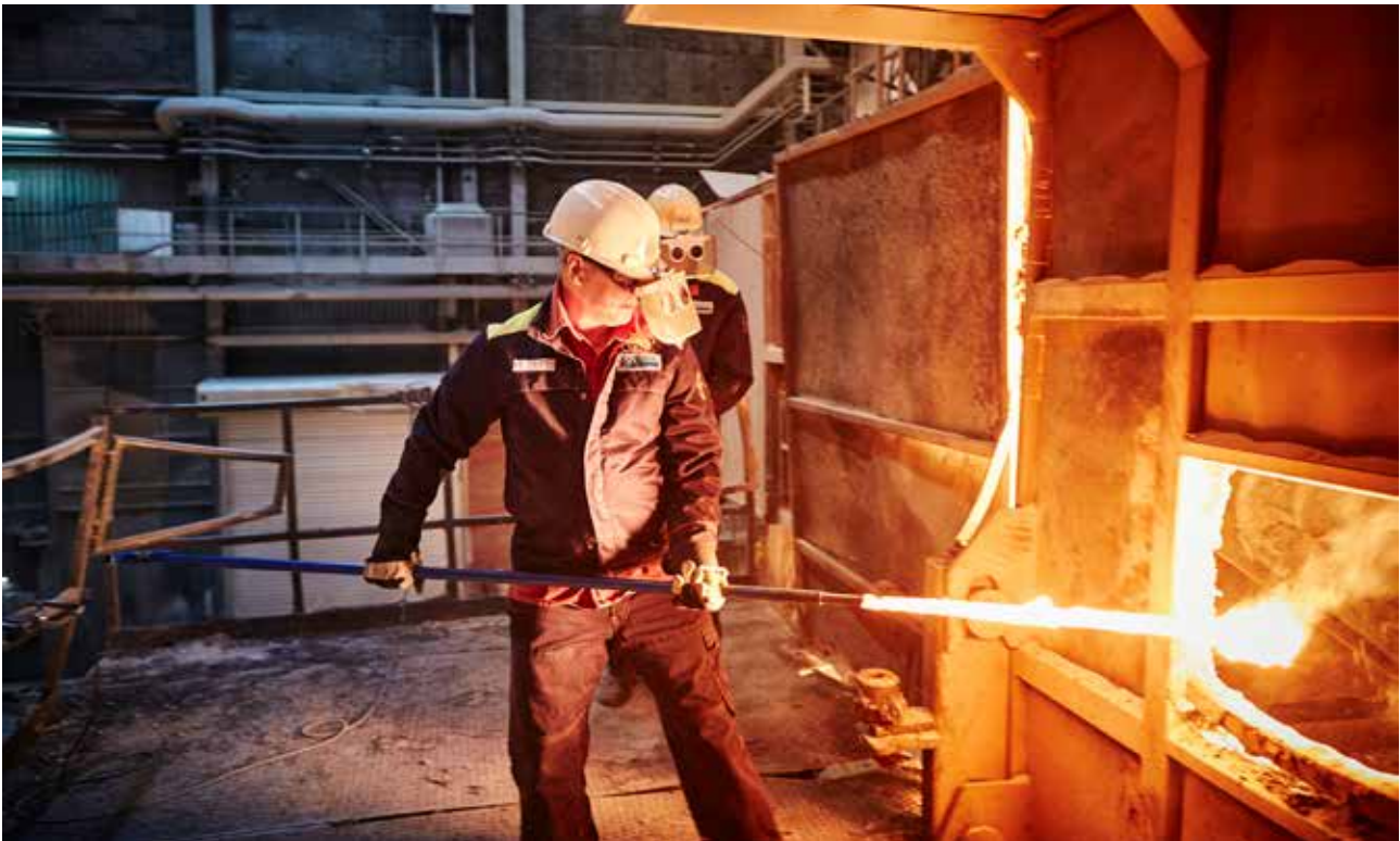
Provtagning i AOD-konverter. Forskningen som bedrivs inom teknikområde 23:s forskningsblock för AOD-konvertrar syftar till att ge ökad kunskap kring färskningsprocessen och driva mot kortare och predikterbara behandlingstider. Foto: Pia Nordlander, Bildn.
