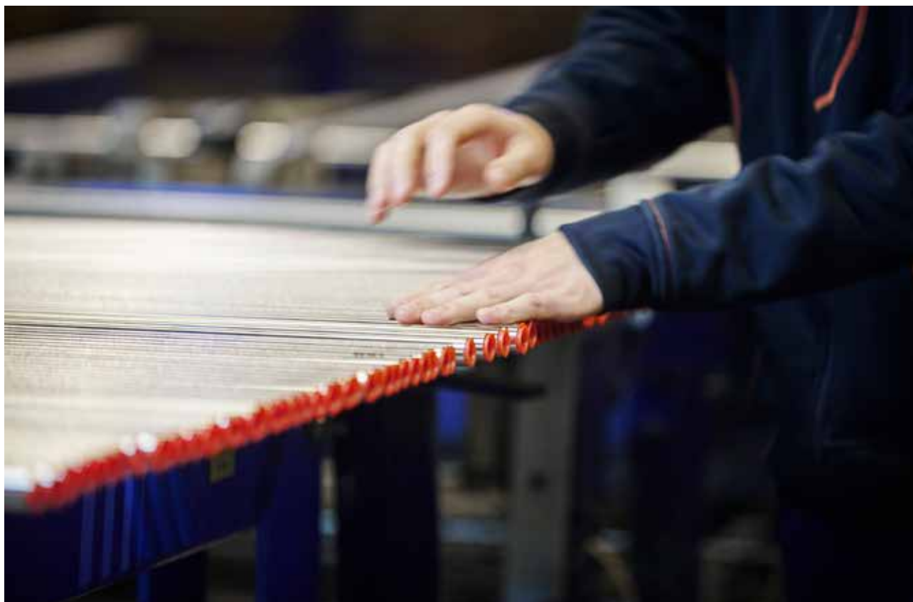
Förberedelse inför ultraljudsprovning av rör hos Sandvik Materials Technology, ett av medlemsföretagen i teknikområde 34, Rör. Foto: Pia Nordlander, Bildn.
