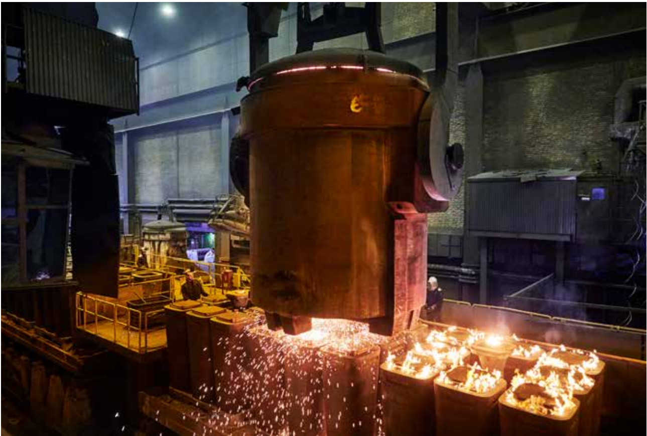
Götgjutning vid Ovako i Hofors. Kokillerna (gjutformarna) fylls med flytande råstål från den hängande skänken. Götgjutning används till exempel när vissa legerade stål av kvalitets skull inte kan stränggjutas, eller då stora dimensioner krävs. I Sverige götgjuts cirka 10 procent av allt stål, en relativt hög andel i internationell jämförelse. Foto: Pia och Hans Nordlander, Bildn.
