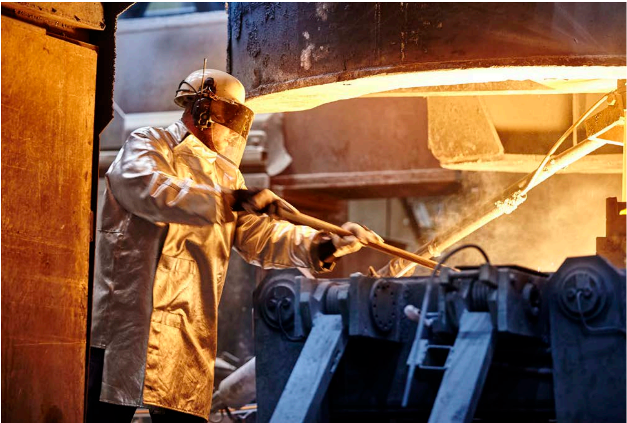
Fördelning av täckmedel i gjutlådan i stränggjutningsanläggningen vid Sandvik Materials Technology. Foto: Pia och Hans Nordlander, BildN.
