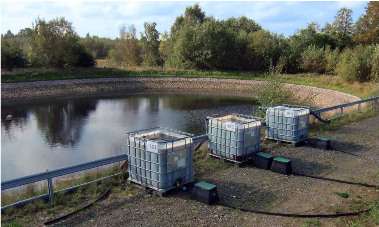
Restprodukt från stålindustrin kan rena vatten. Resultaten i forskningsprojektet MINRENT är mycket positiva. Bland annat testade de i projektet att rena lakvatten från en deponi. Reningen skedde i de tre tankarna. Foto: Björn Haase, biproduktansvarig hos Höganäs och ordförande för teknikområde 55, Restprodukter .
