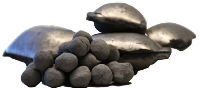
Järnsvamp i form av briketter, HBI (Hot Briquetted Iron) och DRI (Direct Reduced Iron), kan vara ett fossilfritt alternativ till råjärn eller tackjärn som råvara vid ståltillverkning. Foto: Hybrit Development.
