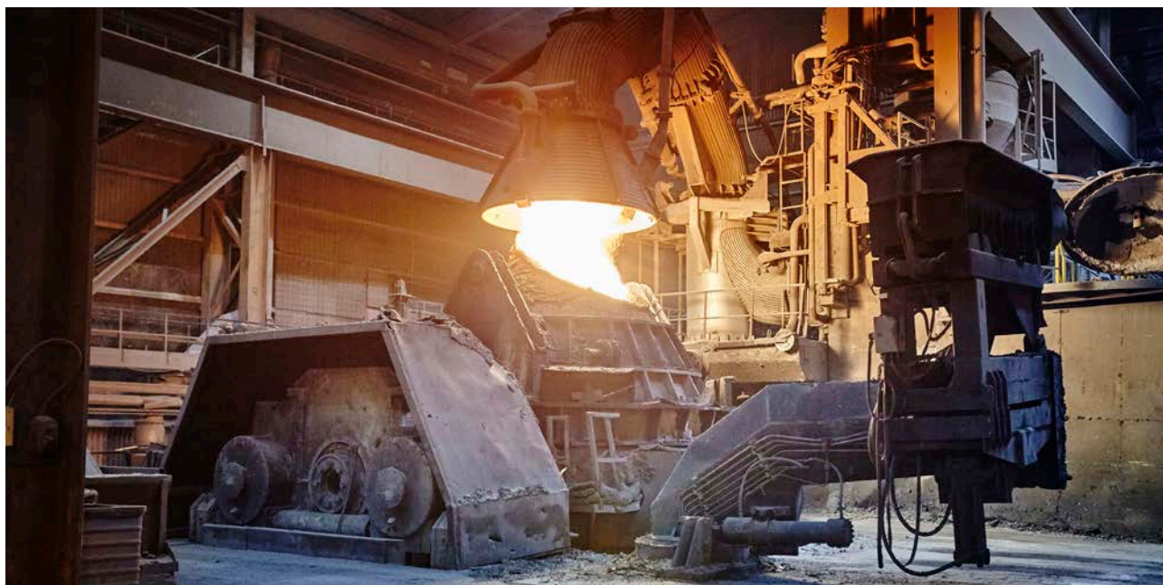
AOD-konverter (Argon Oxygen Decarburization). I konvertern kan kolfärskning, slaggreducering, raffinering, svavelrening och slutjustering av stålet ske. Foto: Pia och Hans Nordlander, BildN.
