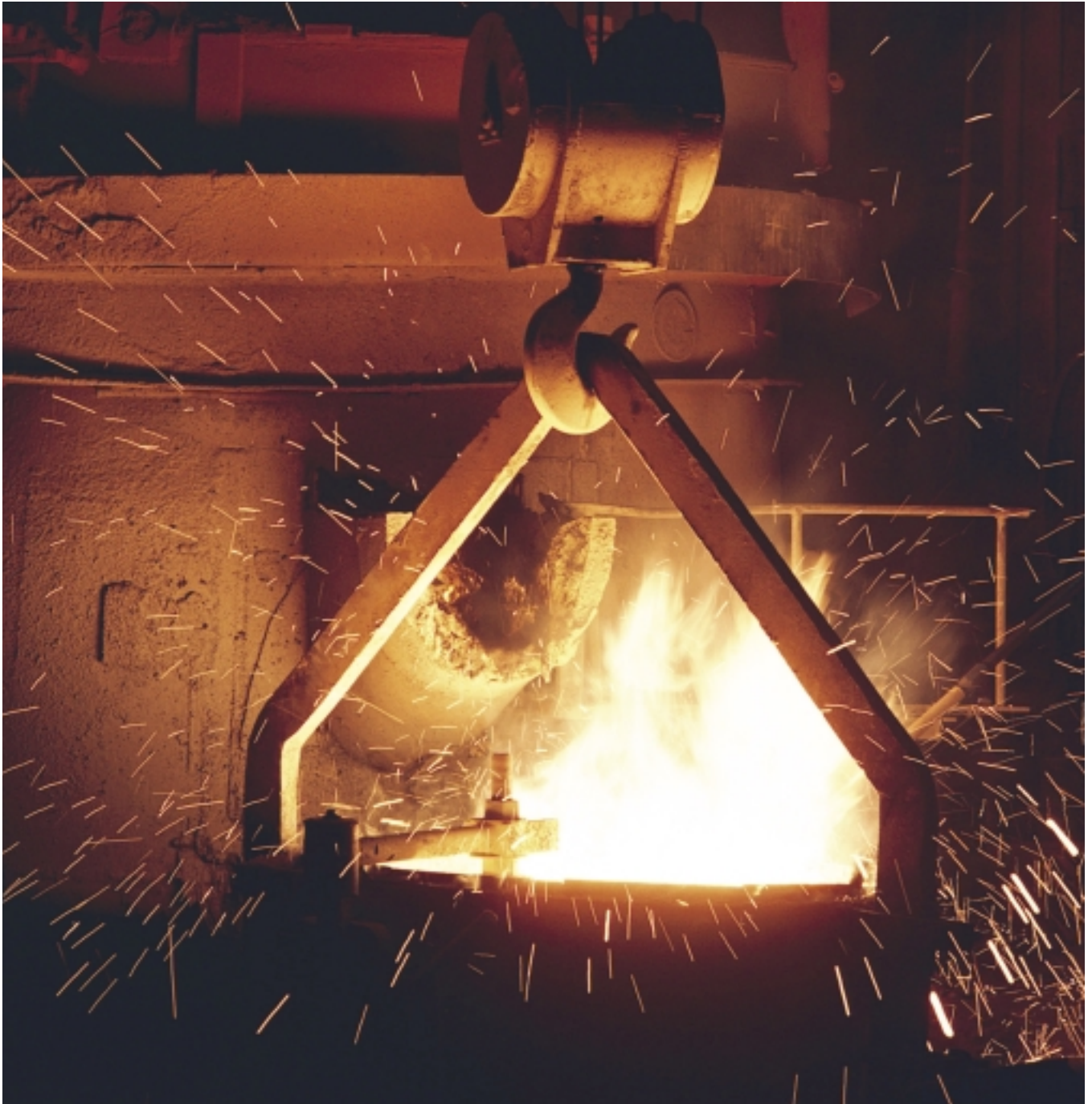
Tappning av det färdiga stålet i en skänk. Skänken fungerar som ett transportkärl och transporterar det smälta stålet från ljusbågsugnen eller konverten till gjutningen.
