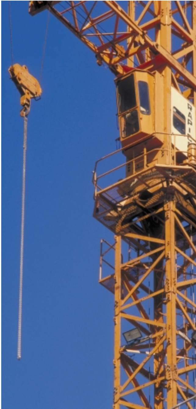
Byggkranar som konstrueras i höghållfast stål kan göras både lättare och smidigare än kranar, med samma hållfasthet, som konstruerats i konventionellt stål.
