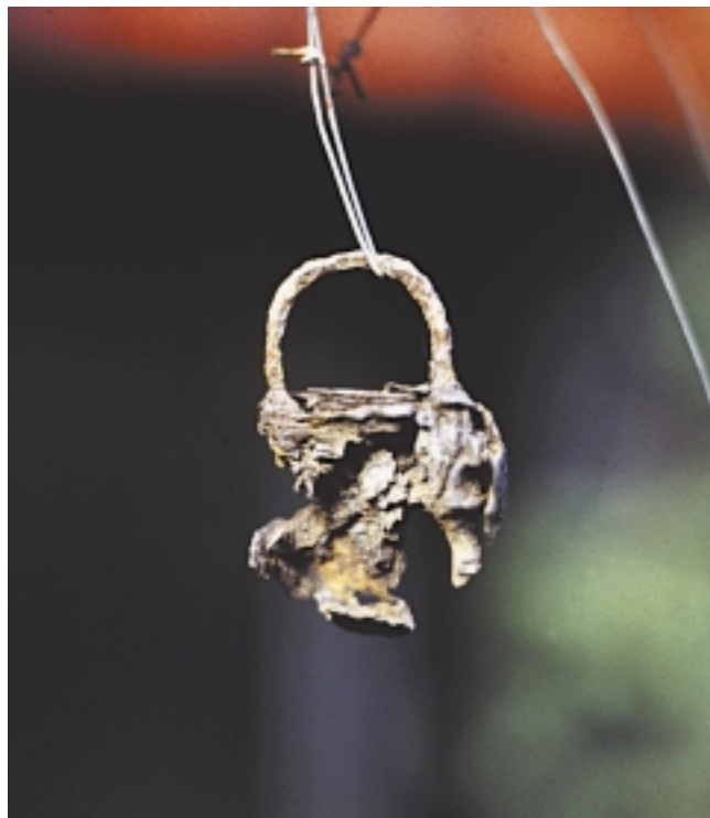
Allmän korrosion: hänglås utsatt för svavelsyra.
