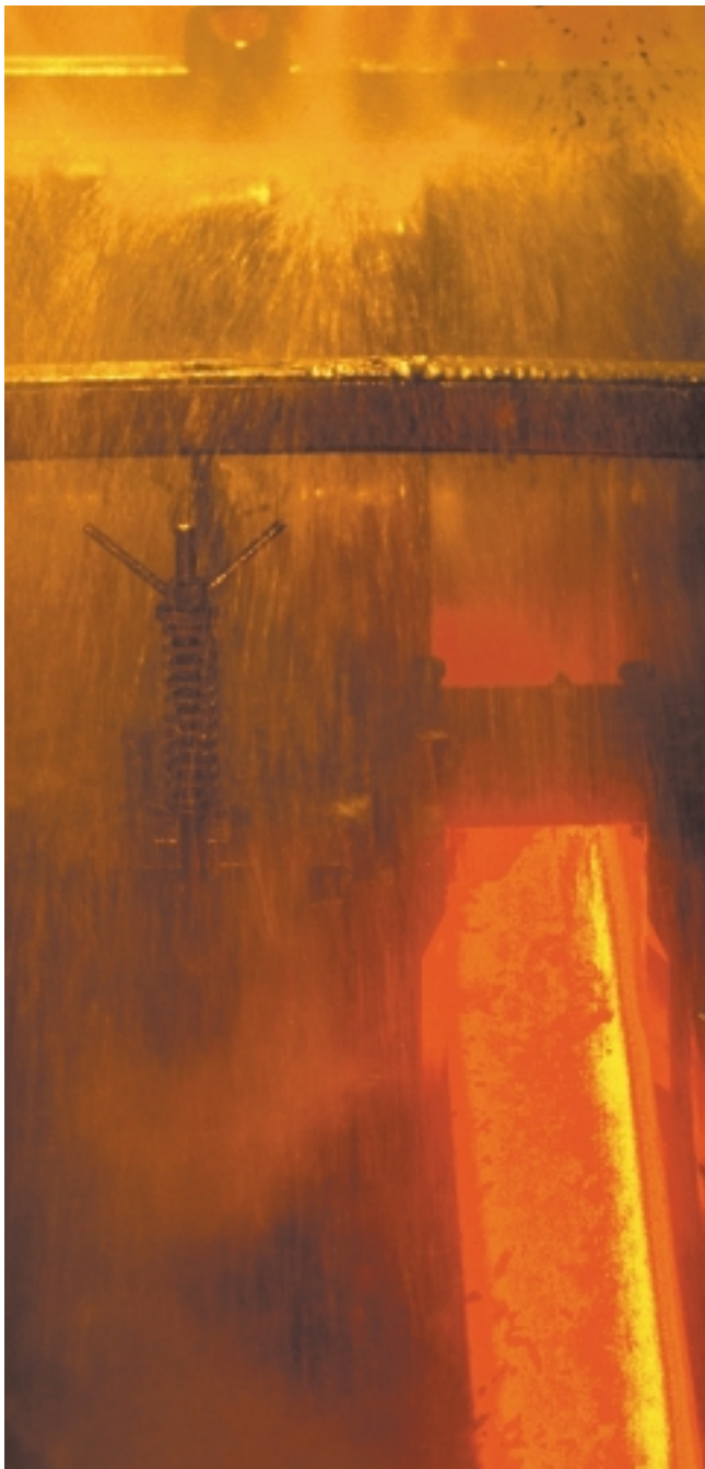
Vid varmbearbetning av stålet används stora mängder kylvatten. Vattnet blir förorenat av oljor och metalloxyder men renas internt och kan därefter användas om och om igen i processen.
