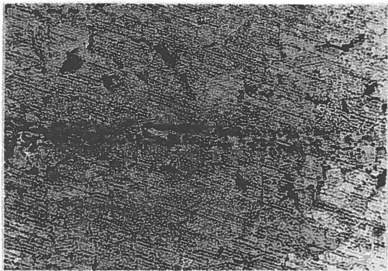
Bild 20: Försök 11:2, 210X, etsat med 1% Nital. Glödskalet har reducerats till metallisk fas.
