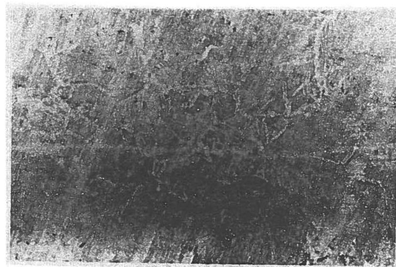
Bild 19: Försök 10:1, 210X, etsat med 1% Nital. Fogen markeras i stort sett endast av en avkolad zon.
