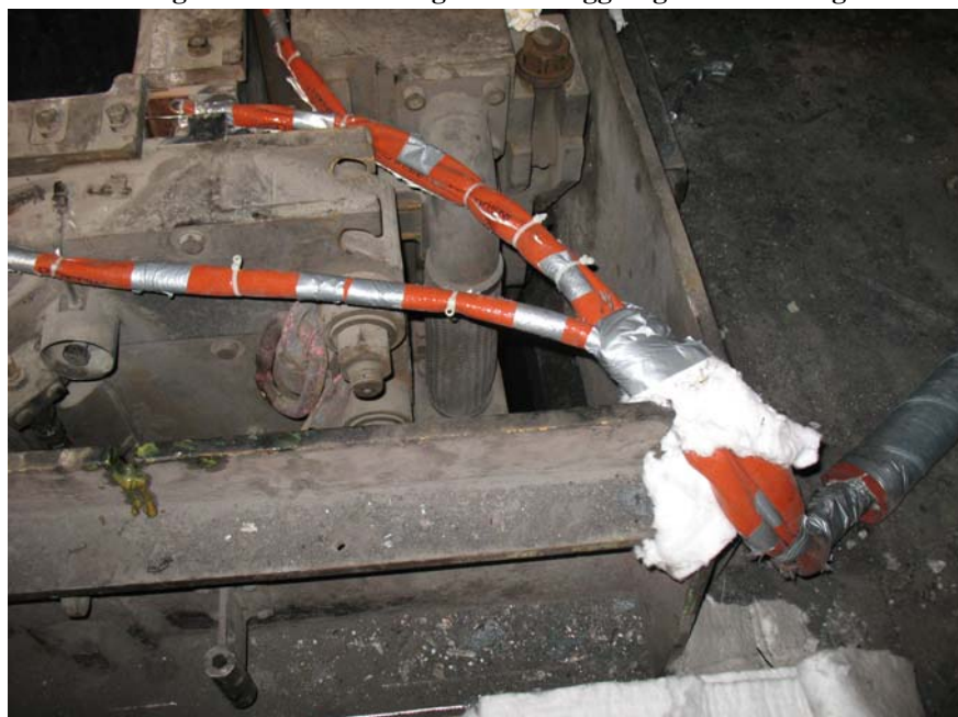
Figur 18. Kabeldragning till den termoelementbestyckade kokillen där manteltermoelementen är skyddade med värmeisolerande matta.
