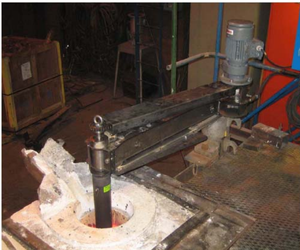
Figur 2. Foto på MEFOS 150 kg:s ugn med roterande stopparuppsättning.
