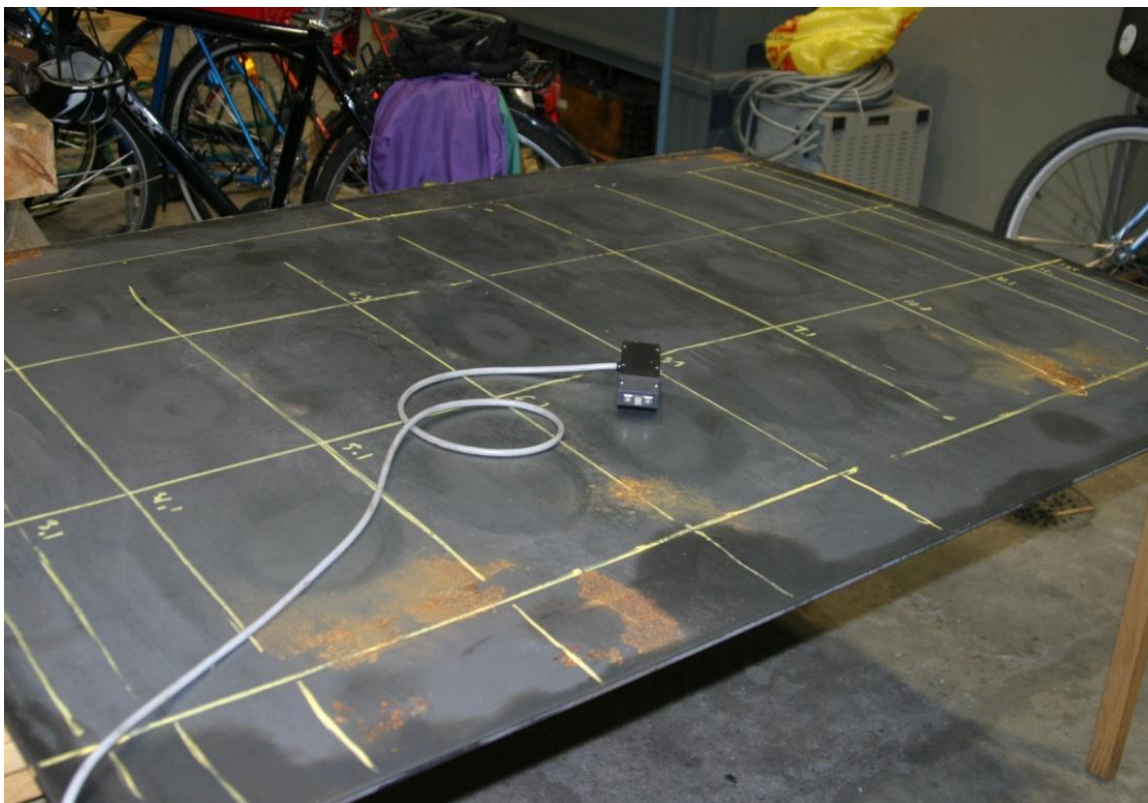
Figur 40. Varmvalsad provplåt 700 MPa oglödgd och mätprobe till MikroMach
