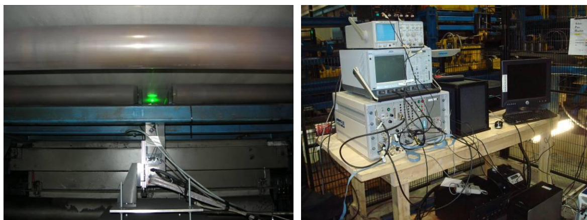
Figur 27. Industriell installation av laserultraljud. Vänster: Fiberkopplat optiska huvudet installerat i formatlinjen. Höger: Spänningsaggregat till lasrar samt insamlingselektronik och datorer.
