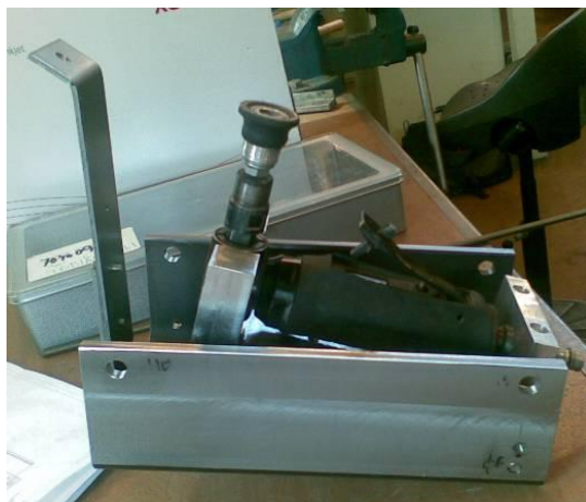
Figur 28. Borstmekanism som användes för att ta bort den lösa oxiden från plåten vid online mätningarna
