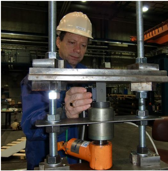
Figur 38. Kalibreringsmätningar, tryck. Eftersom den relativt tunna provstaven ville knäcka ut kapades den ned till 60 millimeters längd.
