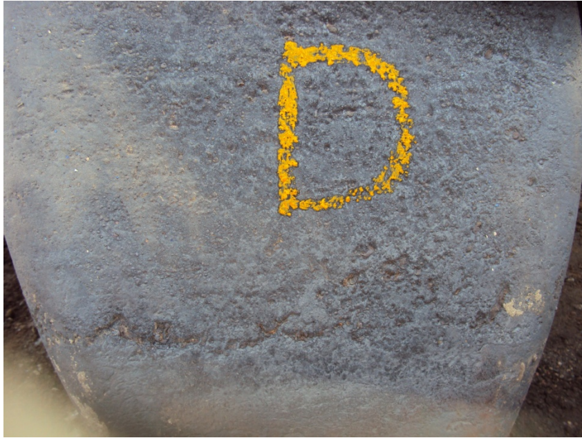
Figur 10 Göt 16D, grov rand med gjutpulver, 20cm ovan botten
