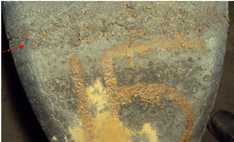
Figur 6. Visar ett tydligt stråk av gjutpulverintryck över hela götets sida vid röd pil. (göt 15A)
