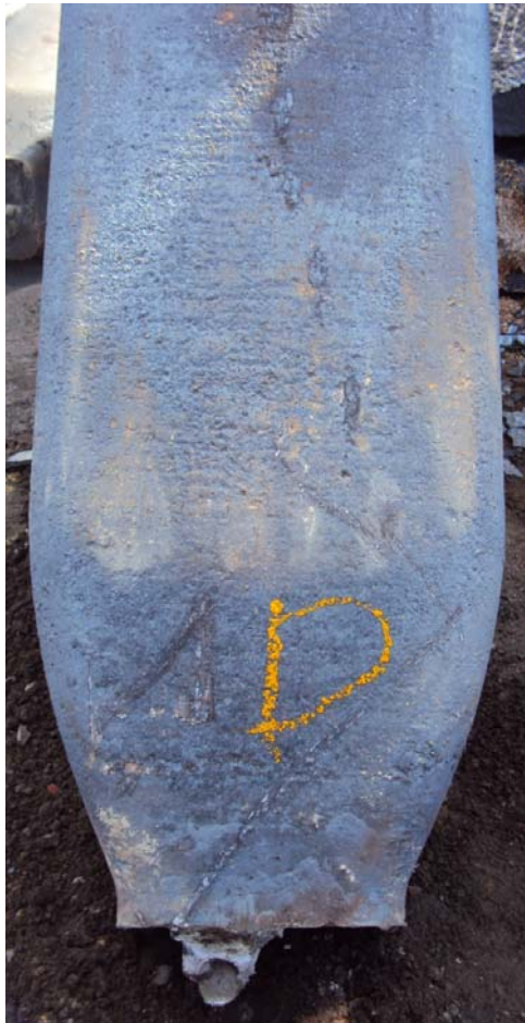
Figur 11 Göt 12 D1, tydliga ränder 40 – 100 cm ovan botten, 145 cm ovan en stor grop.
