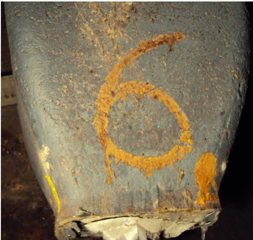
Figur 8. Visar inget stråk av gjutpulverintryck. (göt 6A)
