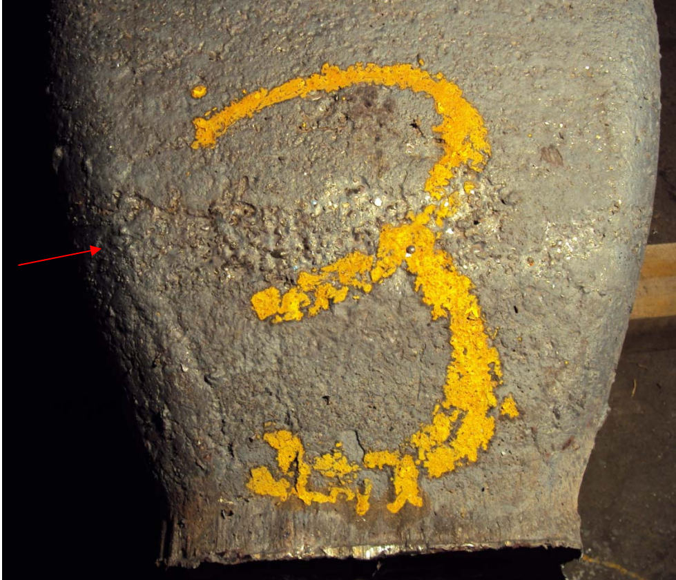
Figur 7. Visar ett tydligt stråk av gjutpulverintryck över hela götets sida vid röd pil. (göt 3A)
