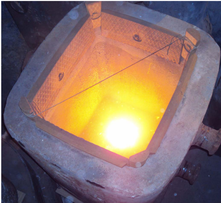
Figur 24. Visar hur gjutpulverpåse hängts över boxkilar.
