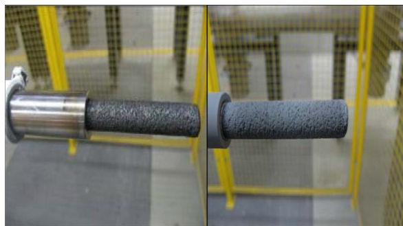
Figur 34: Provbit före och efter beläggning med YSZ
