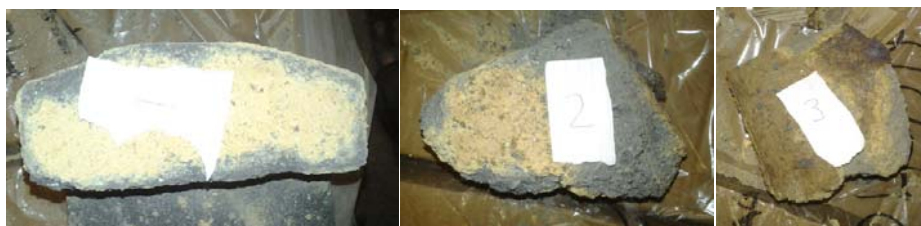
Figur 14. Försök 2. Oskyddat tegel (t.v.) och tegelbit 2 skyddad med slagg på ena sidan (mitten) samt tegelbit 3 skyddad med slagg på ena sidan (t.h.)
