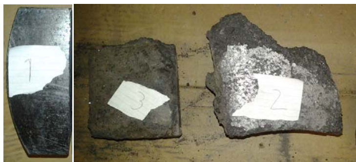
Figur 13. Oskyddat tegel (t.v.) Tegel med en sida täckt med slagg (t.h)
