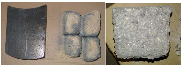
Figur 12. Bild på nytt tegel (t.h.) och tegel efter försöket (mitten) samt en närbild på en tegelbit som borstats ren från löst material (t.v.).
