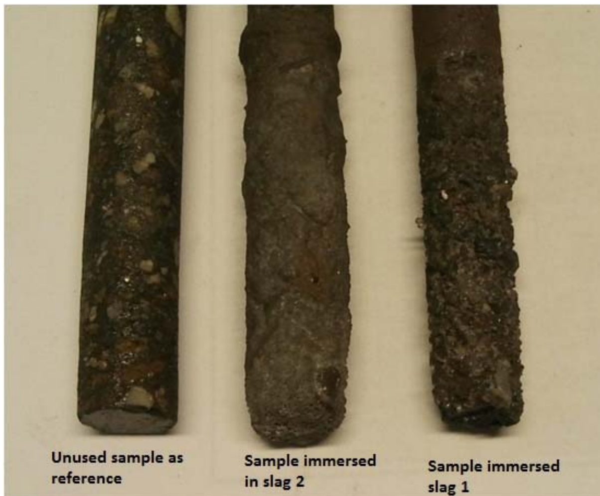
Figur 25. Utseende på provets yta efter nedsänkning i slaggen vid 1650^{\circ}\text{C} i 60min och med en rotations hastighet på 200 rpm.
