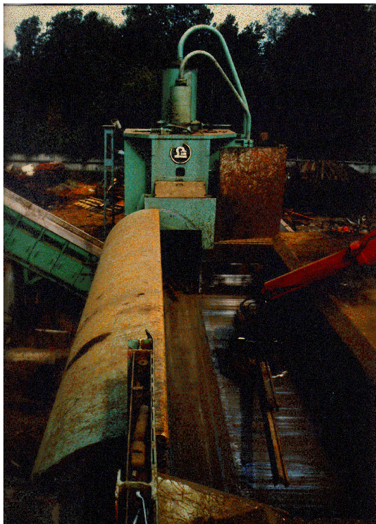
Stationär skrotsax med tryck på upp till 1000 ton.
