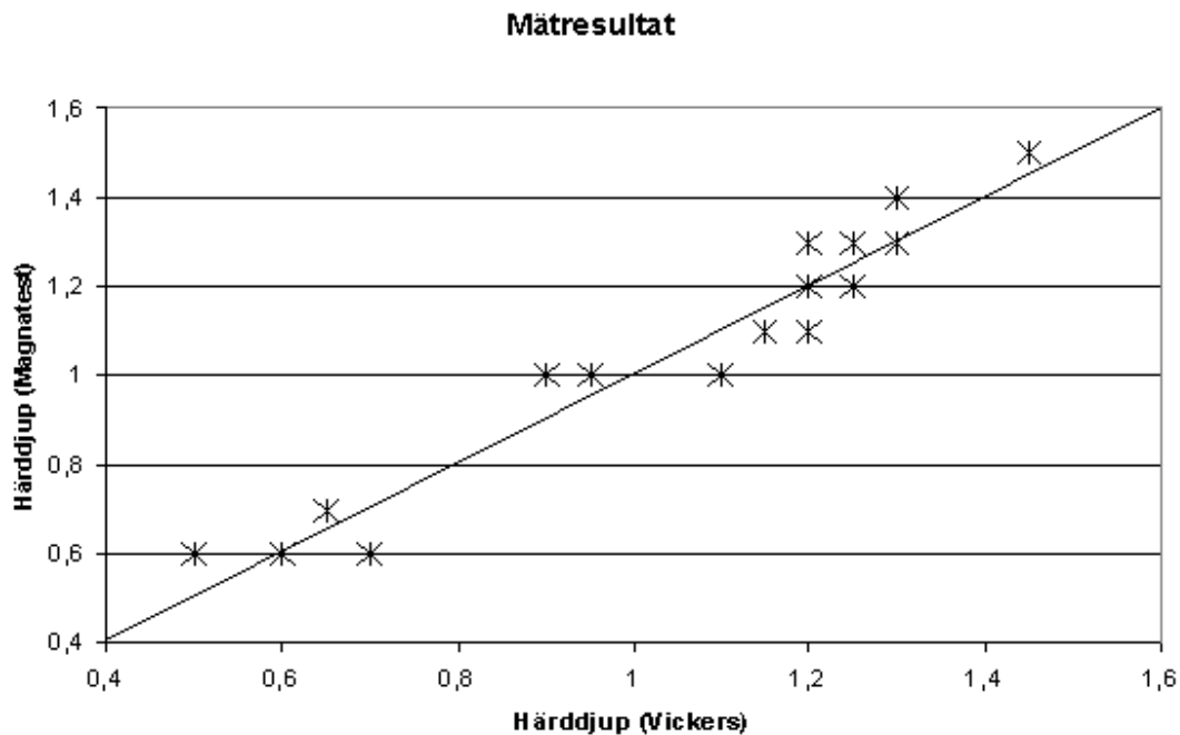
Figur 17. Jämförelse av härdjup som mäts upp med Magnatest S och med konventionell vickersmätning.
