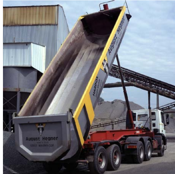
Figur 54. Lastbilsflak i 5 mm tjock HARDOX 450 ersätter 8 mm tjockt konventionellt stål vilket ger minskad vikt, ökad lastförmåga och lägre bränsleförbrukning, SSAB
