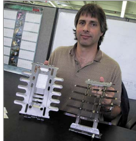
Figur 52. Svankstöd till bilstol i Docol 1400 (till vänster) ger halva vikten och 20 gånger högre produktivitet, SSAB
