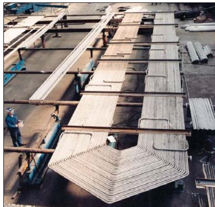
Figur 56. Tillverkning av överhettarslingor i stål Sanicro 25 till panna för kraftproduktion, Sandvik
