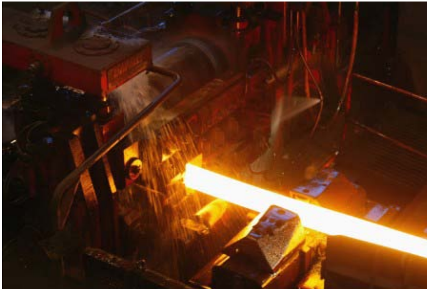
Figur 48. Varmvalsning av stång. Källa: Jernkontoret
