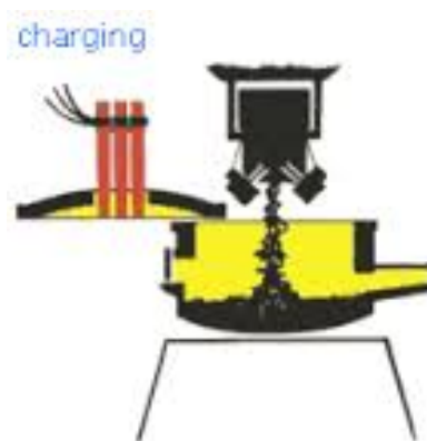
Figur 3. Elektrisk smältugn- ljusbågsugn-för stålskrot och charging av ugn med stålskrot
