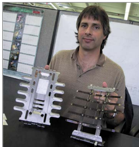
Figur 4.2. Svankstöd till bilstol i Docol 1400 (till vänster) ger halva vikten och 20 gånger högre produktivitet, SSAB [2]
