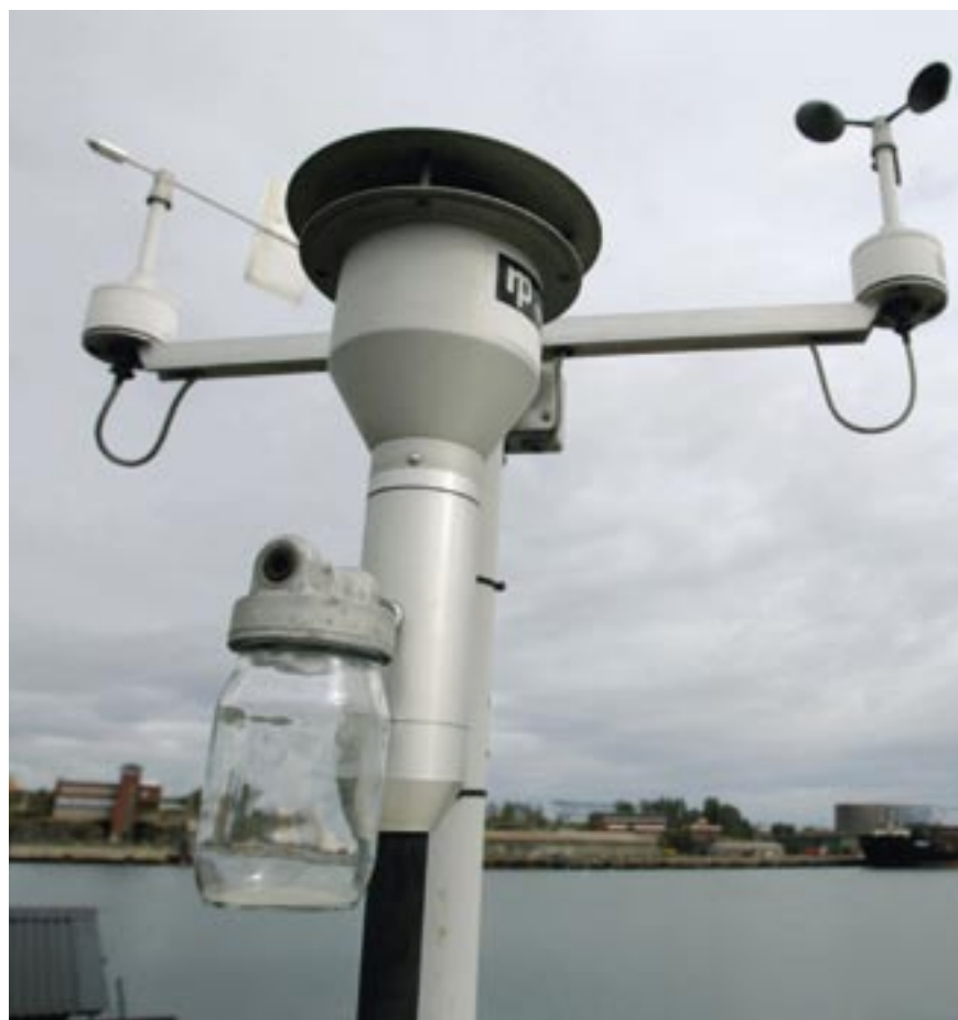
Miljöstation för provtagning av luft. SSAB Oxelösund.
