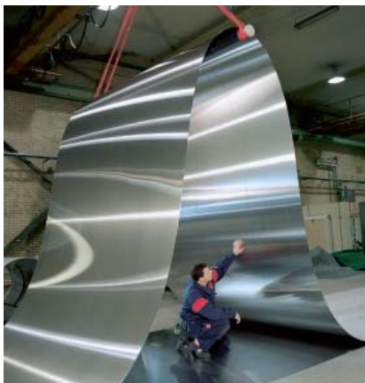
Breda stålband lanserades till pappersmassaindustrin, där stålbandet är en kritisk komponent i processen. Stålbanden bidrar till att öka kundernas produktivitet samt förbättrar slutprodukternas kvalitet.
