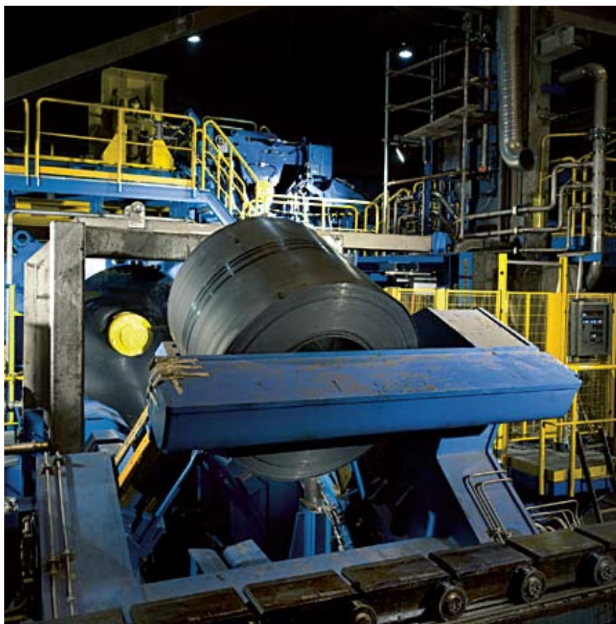
Haspel 4 invigdes i varmvalsverket i Borlänge. En förutsättning för att klara produktion av alltmer höghållfasta stål.
