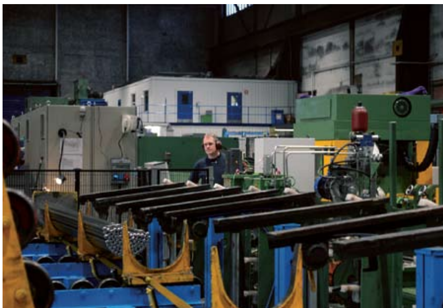
Nya vitala delar (sax, rikt, fasenheter) i en av Boxholm ståls ringdragbänkar.
