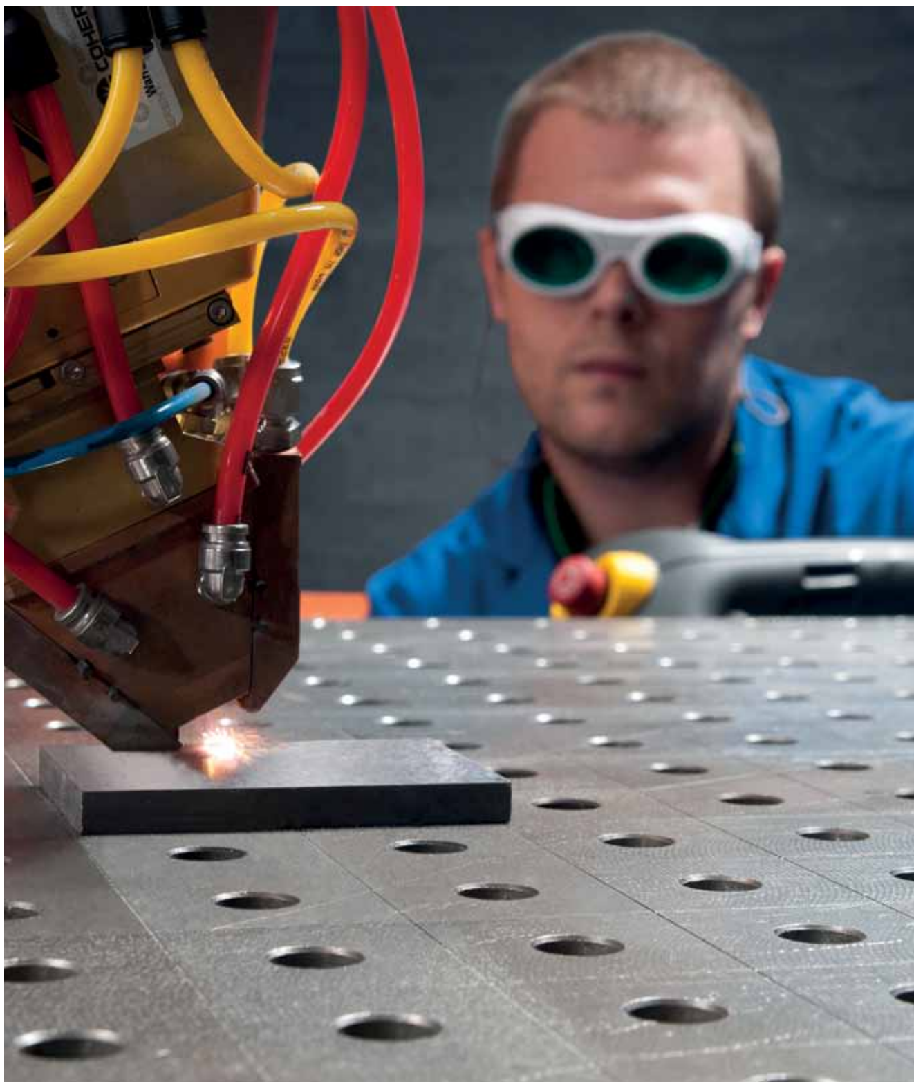
Ytbeläggning med höglegerat metallpulver med hjälp av en laserrobot vid Höganäs AB.
