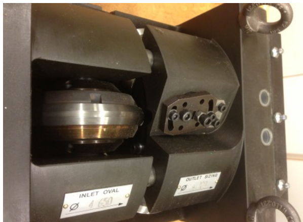
Roller-die-kassett för tråddragningsförsök i pilotskala vid Örebro universitet.
