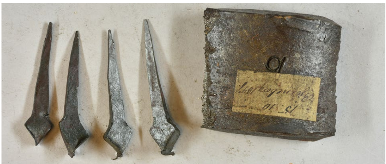
Exempel på föremål i den Bergshistoriska samlingen: Stångjärn och hästkosöm tillverkade i Björneborg 1847, i ursprunglig ask med etiketter med data. Foto: Mimmi Strömberg/Tekniska museet. Källa: digitaltmuseum.se/tekniskamuseet
