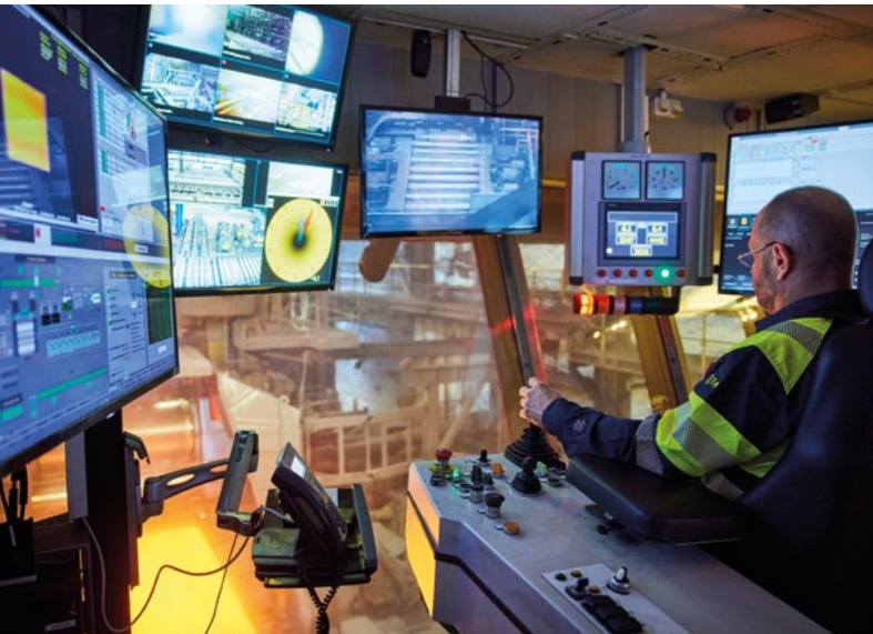
Reglerare Torbjörn Wiktorsson vid spakarna i manöverhytten under pågående valsning i Outokumpus kvartovalsverk för plåt i Degerfors. Foto: Pia Nordlander.
