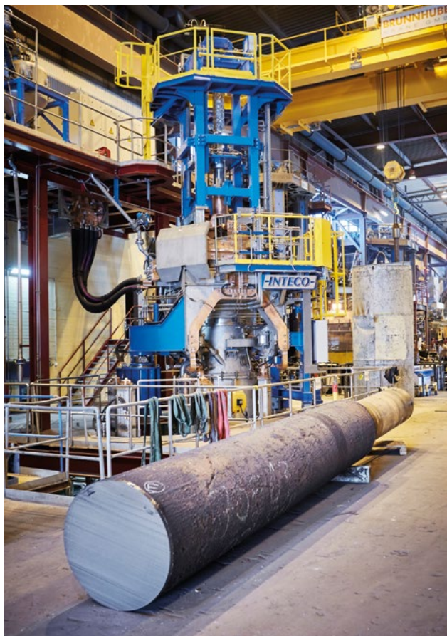
ESR-göt från Uddeholms AB i Hagfors. ESR (Electro Slag Refining) är en efterbehandlingsprocess där stålet genomgår omsmältning, vilket ger det en struktur och en renhet som bland annat resulterar i ökad utmattningshållfasthet. Foto: Pia Nordlander/Jernkontorets bildbank.
